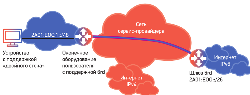
Рис. 7. Схема работы технологии 6rd.
